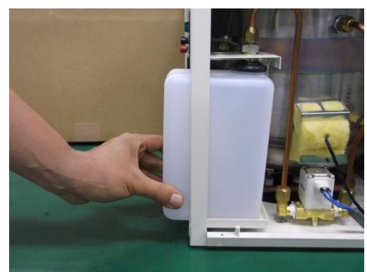
⑥排気口が排気ボトルに差し込まれていることを確認する。(排気ボトルが抜けないこと)
