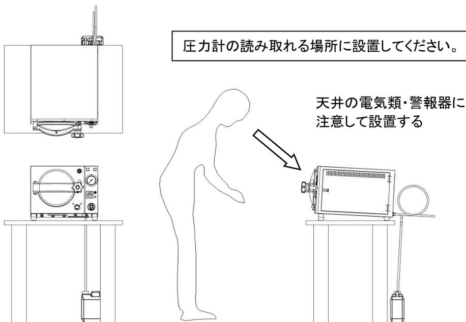
排水溝・排水ピット等の排水設備のない場合は、耐熱容器を設置してください。
