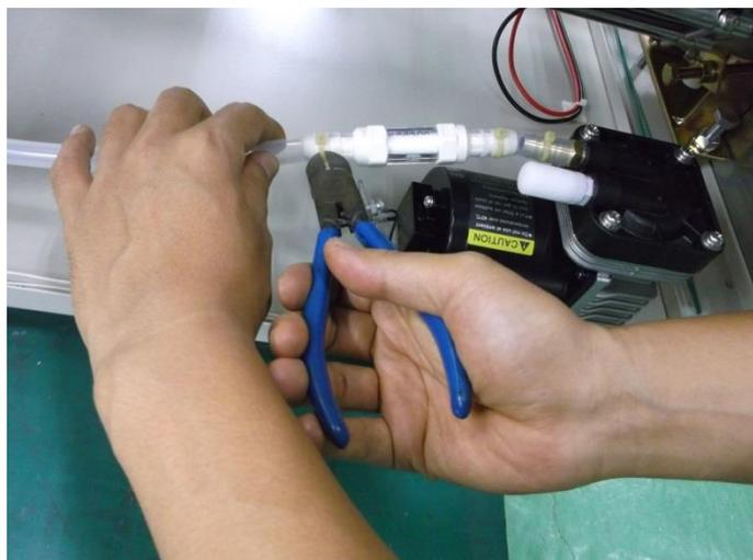
4. IN 側と OUT 側に注意し、新品のエアフィルターにシリコンホースを差し込む。
