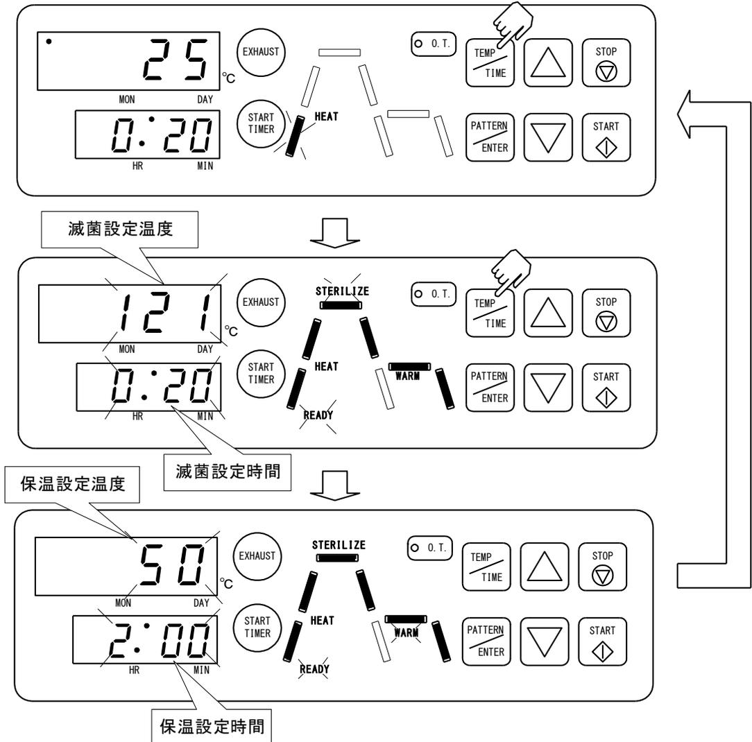
排気設定 ON のときは EXHAUST【排気】ランプが点灯します。
