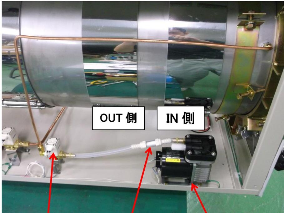
送風電磁弁 「IN」「OUT」を確認すること 送風ポンプ
