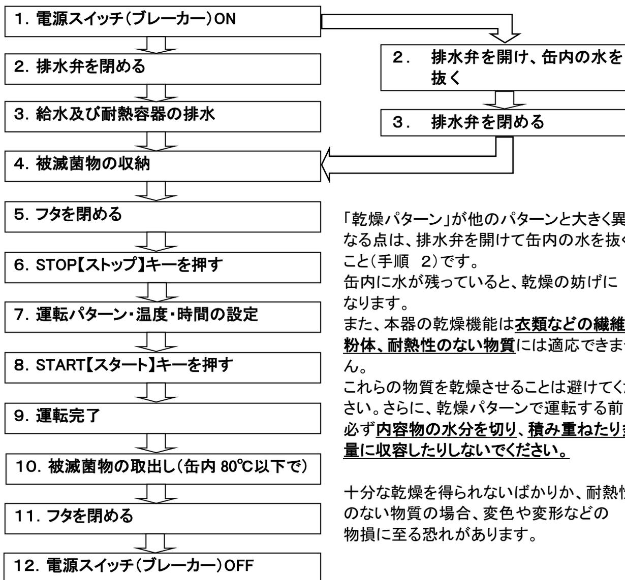
「乾燥パターン」が他のパターンと大きく異なる点は、排水弁を開けて缶内の水を抜くこと(手順 2)です。
