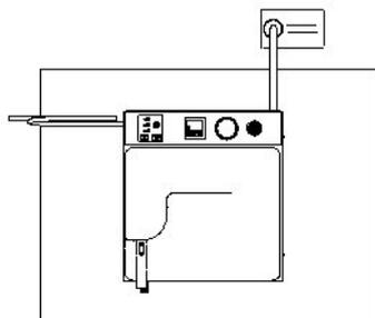
天井の電気類・警報器に注意し、圧力計の読み取れる場所に設置してください。
