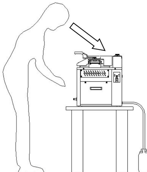
排気ボトルは本器向かって、背面または側面後方のあやまって倒さない場所に設置してください。(『4.5 付属品の取り出し・設置』参照)
