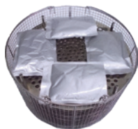
平型パウチ(平置き):60個 (180mm×140mm×20mm)
