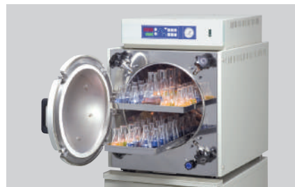
③上段トレイ+下段トレイ 100mL三角フラスコならば108個収納可能
