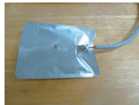
品温センサーを 試料の中心にセット
