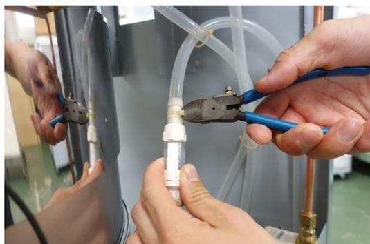
5. IN 側と OUT 側に注意し、新品のエアフィルターにシリコンホースを差し込む。
