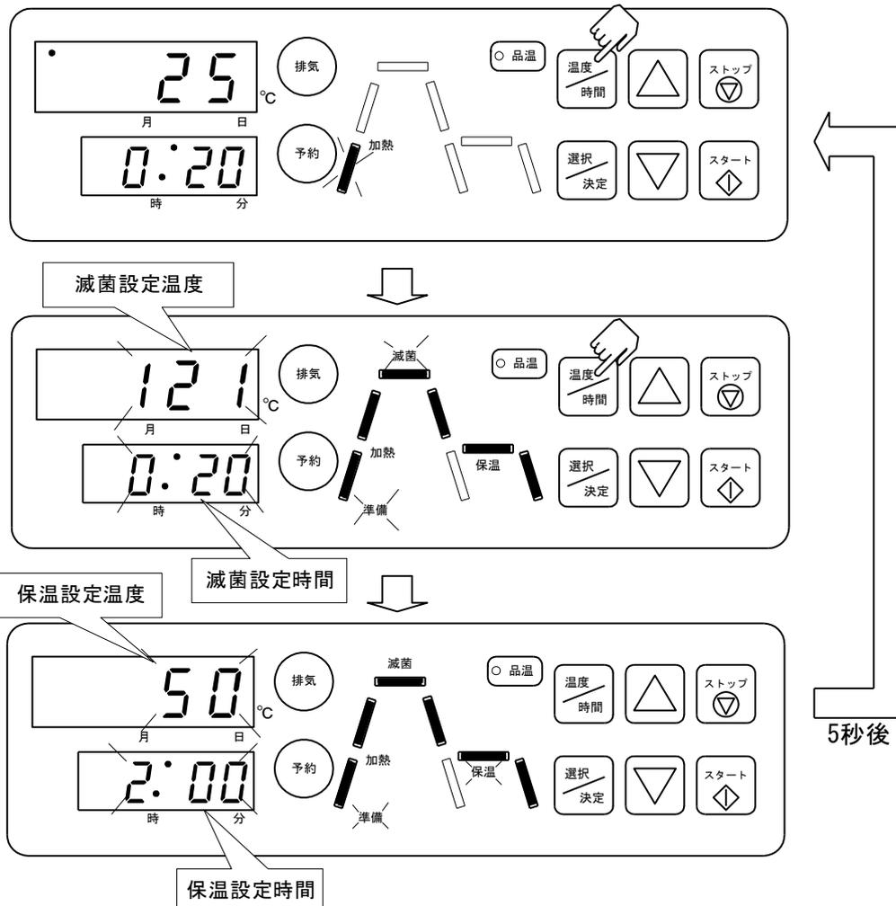
排気設定ONのときは排気ランプが点灯します。5秒経過すると自動的に元の表示に戻ります。
