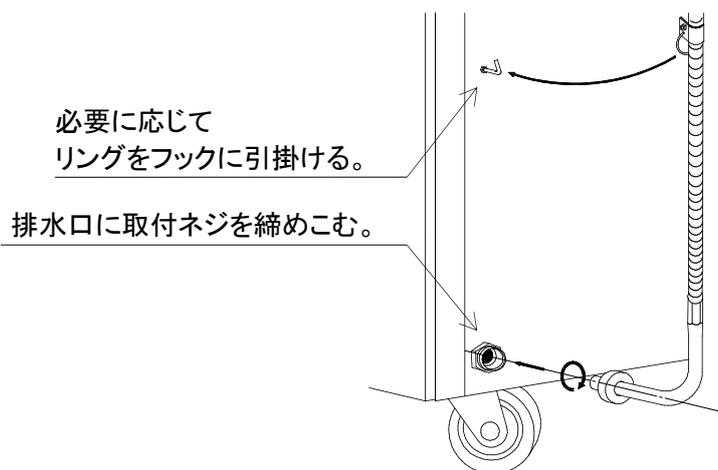
図 1 ステンレス排気・排水ホースの取付方法
