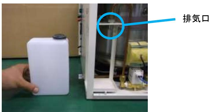
②排気ボトルを傾けながら挿入口に差し込み、下部を奥へ押し込む。
