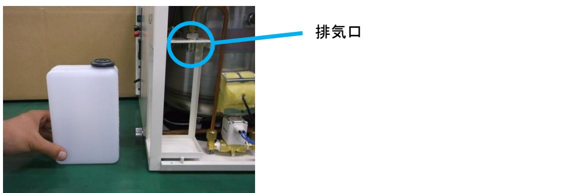
②排気ボトルを傾けながら挿入口に差し込み、下部を奥へ押し込む。
