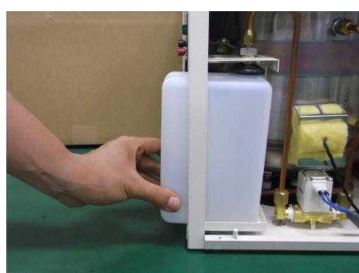
⑥排気口が排気ボトルに差し込まれていることを確認する。(排気ボトルが抜けないこと)
