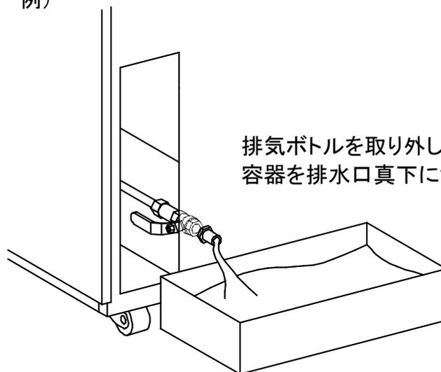
排気ボトルを取り外し、ステンレスバットなどの浅めの容器を排水口真下に置いて排水弁を開く。
