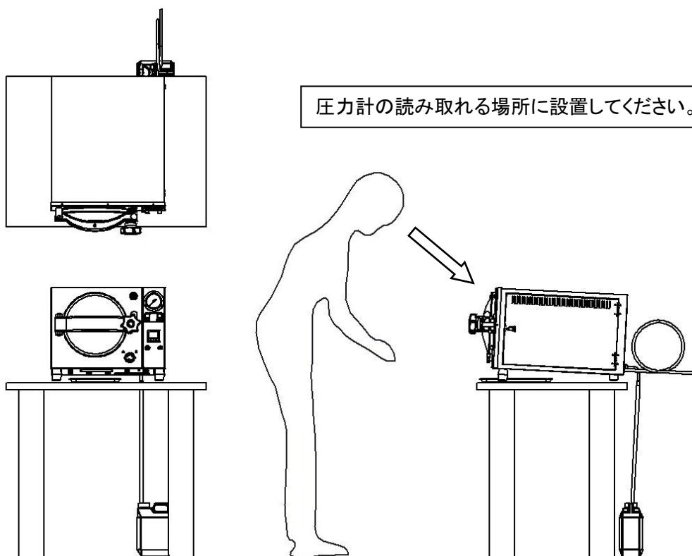
排水溝・排水ピット等の排水設備のない場合は、耐熱容器を設置してください。
